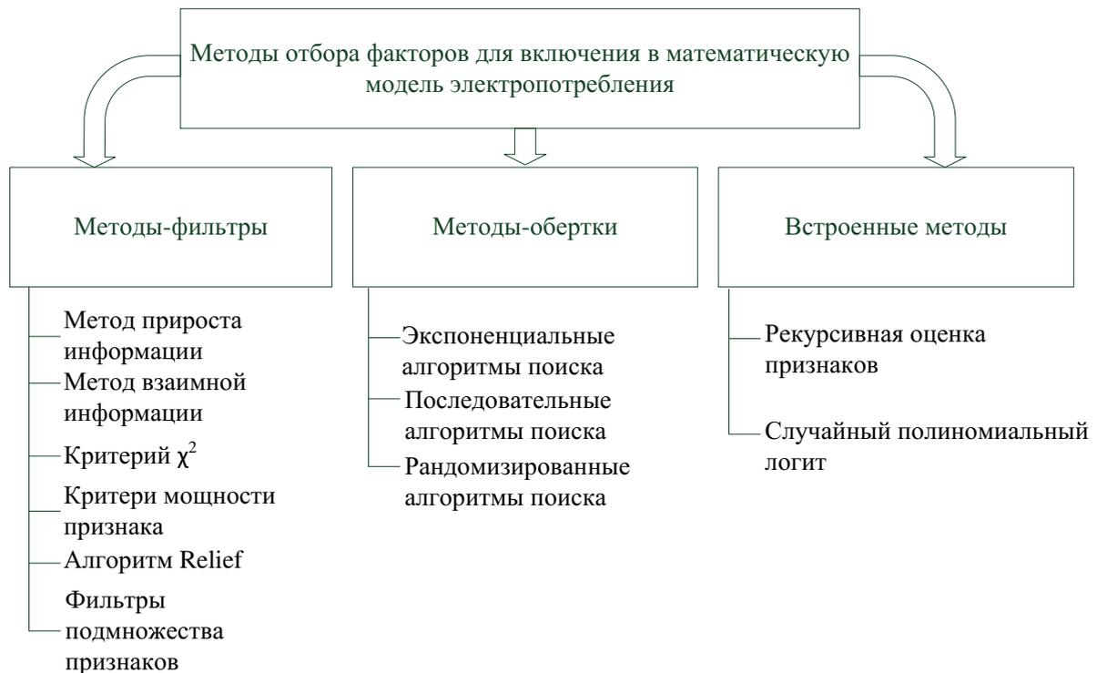
Рисунок 2.5 – Классификация методов отбора факторов для включения в математическую модель расхода электрической энергии
