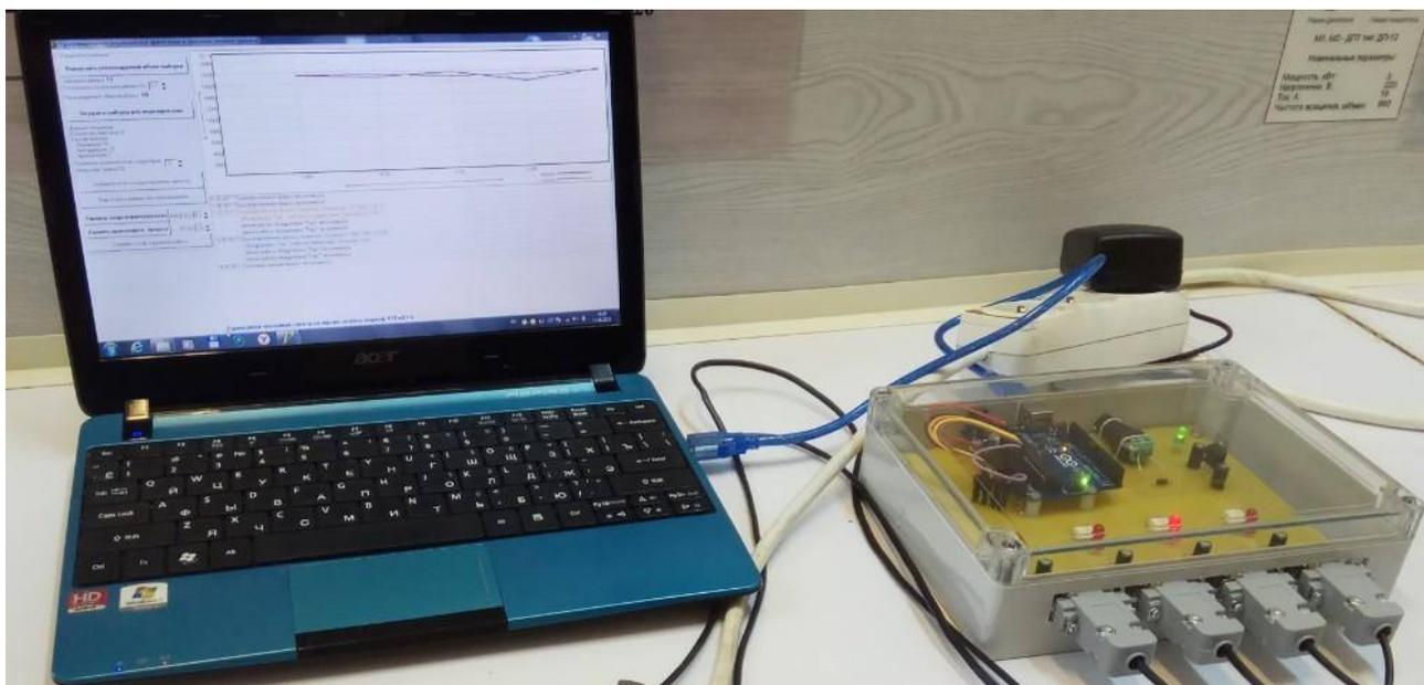
Рисунок 7.22 – Внешний вид опытного образца устройства учета времени работы электрооборудования
